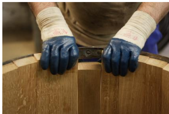
Fig. 1. Inicio (izda.) y finalización (dcha) del armado manual de la barrica.
