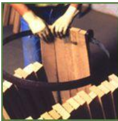
Fig. 1. Inicio (izda.) y finalización (dcha) del armado manual de la barrica.
