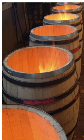
Fig. 2. Armado de la barrica por uno de sus extremos (izquierda) y tostado de la barrica (derecha).
