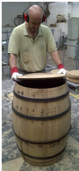
Fig. 3. Operación de fondado de la barrica (izquierda) y colocación del fleje (derecha).
