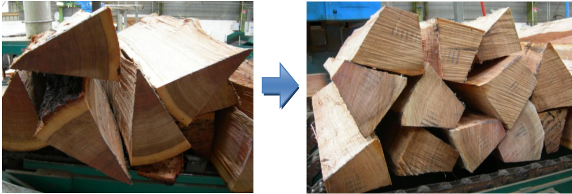
Fig. 2. Operación de corte de albura y médula en cada uno de los cuarterones obtenidos mediante hendido.
