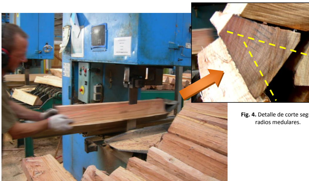
Fig. 3. Operación de corte longitudinal del cuarterón para la obtención de tablas.
