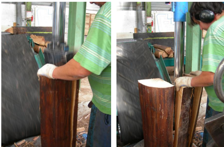
Fig. 1. Operación de hendido sobre un tronco de roble francés para obtener los cuarterones.
